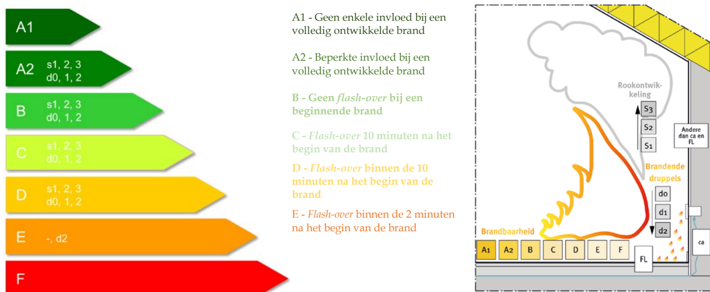
Afbeelding 4 – Schematische voorstelling van de brandreactie klassen.
