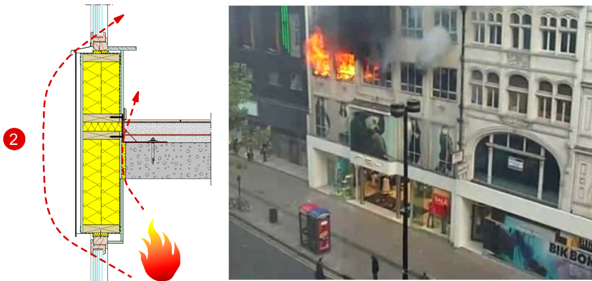
Afbeelding 10 – Inwendige en uitwendige brandoverslag. Links: principeschema; rechts: vlammen die ontsnappen uit een brandende bouwlaag.
