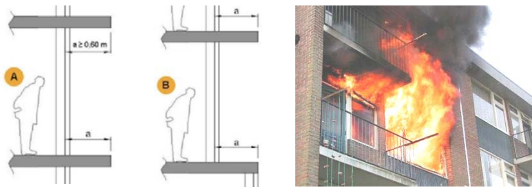
Afbeelding 20 – Vlamdichte horizontale uitsteek E 60 van minstens 60 cm.
